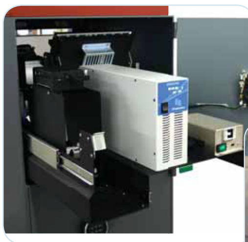
Terminal bancário com no break incorporado
